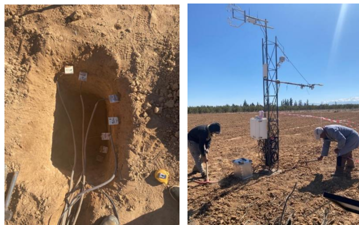
Figure 7: Installation du système d'Eddy covariance pour la mesure de différentes composantes du bilan hydrique.
