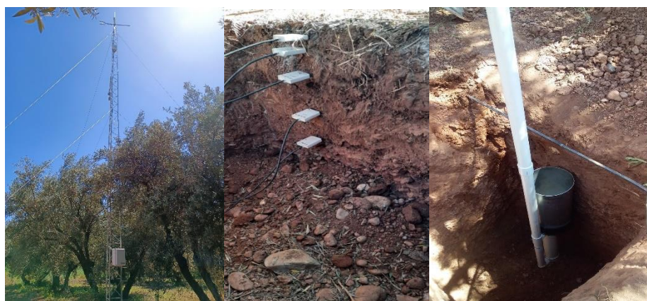
Figure 8: Installation du système d'Eddy covariance pour la mesure de différentes composantes du bilan hydrique.
